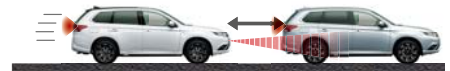
先行車が減速・停止すると、それに合わせて減速・停止。
