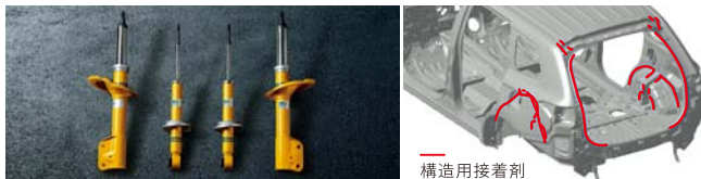
BILSTEIN社製ショックアブソーバー 構造用接着剤によるボディ剛性強化部 ※実際の製品は写真と異なる場合があります。(イメージ)
